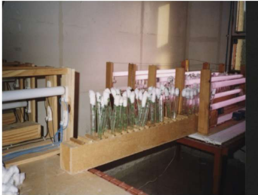
Figura 10: Ensayo en cámara climatizada, realizado con plantas de alfalfa, en condiciones de fotoperíodo y temperatura controladas.
