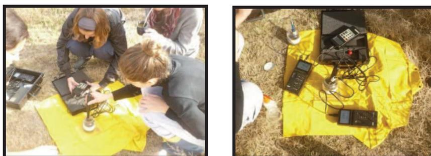
**Fig. 5 a y b.** Empleo de Oxímetro digital Lutron DO- 5510, pHmetro/ISE portátil y Conductímetro digital 105 Orion.
