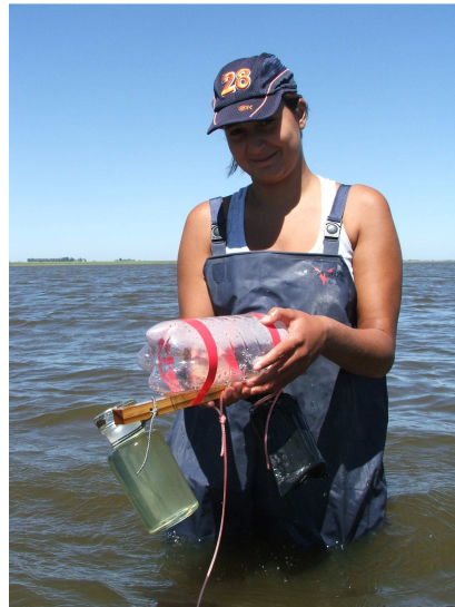
Figura 5.3: Armado del conjunto de las botellas clara y oscura
