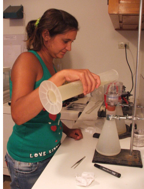
Figura 5.4: Filtrado de agua para la determinación de la concentración de clorofila a .
