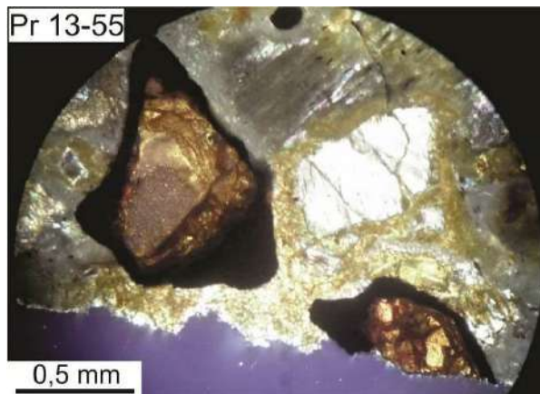
Figura 14. Fotomicrografía a niculos cruzados de anfíbol incluido en ortopiroxeno con alteración de hematita en sus bordes.
