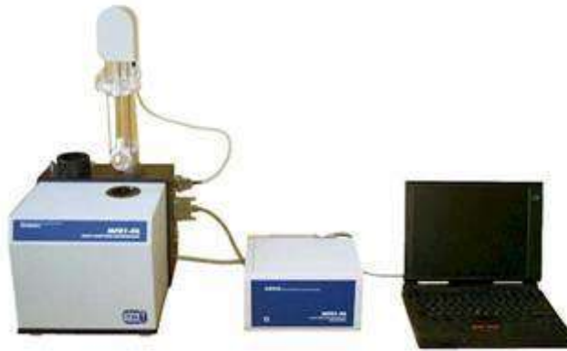
Figura 4.9: Susceptibilímetro Kappabridge KLY - 2.02 (Geofyzika Brno), utilizado para medir anisotropía de la susceptibilidad magnética (ASM).
