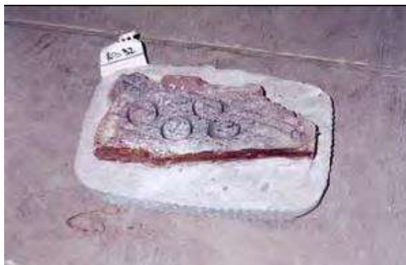
Figura 4.6: Muestra de mano horizontalizada utilizando un molde de cemento, donde se observa la marca de orientación realizada en el campo y los orificios de los testigos obtenidos.
