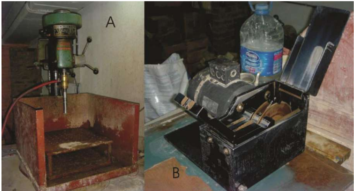
Figura 4.7: Imagen de la perforadora utilizada para extraer los cilindros (A) y de la rebanadora para cortarlos en especímenes estándar (B).
