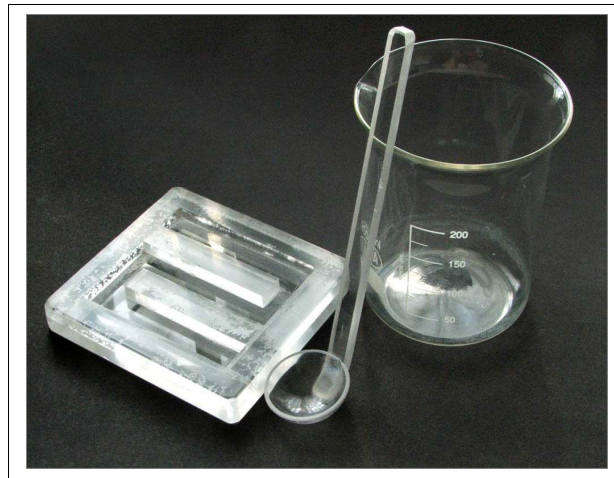
Figura 4: Cámara de Bogorov y submuestreador de Russell de 5 ml
