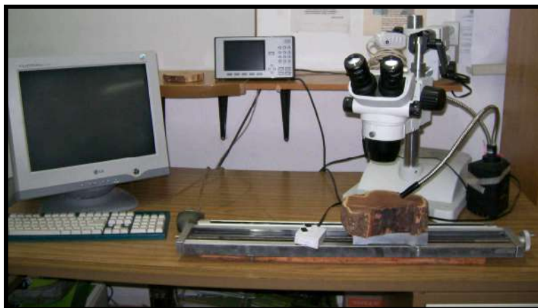
Figura 10. Sistema de medición VELMEX Inc del Laboratorio de Dendrocronología de la UNSL.
