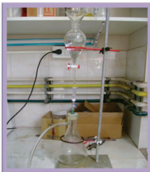
Figura 7. Fotografía del equipo armado para la Extracción en Fase Sólida.
