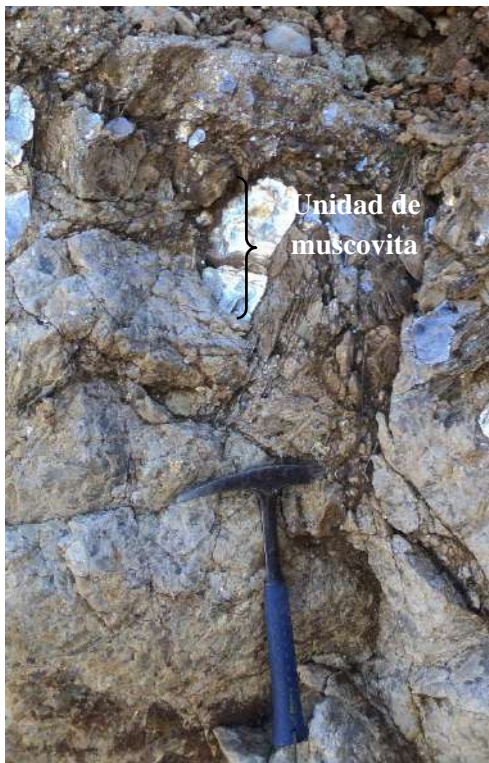
Figura 9c: unidad de muscovita en la zona intermedia de la labor G. Se observan las grandes láminas de hasta 20 cm de largo.
