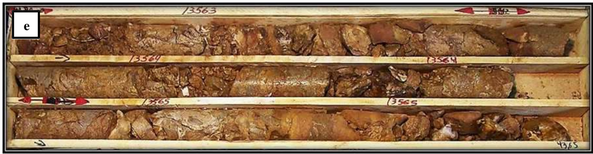
Figura N° 26: Fotografías de las variaciones litológicas de la sección N_175. a) Toba lapillítica moderadamente seleccionada con predominio de cristaloclastos y pequeños vitroclastos alterados de 191,5 a 194,46 m. b) Brecha hidrotermal que se encuentra relacionada con la estructura mineralizada, en este caso se presenta con abundantes óxidos de hierro y silicificada, de 33,43 a 36,16 m en la perforación. c) Toba lapillítica matriz sostén, pobremente seleccionada, dominada por fiammes con textura eutaxítica y contenido variable de litoclastos, esta unidad es la de mayor representatividad en las perforaciones de 106,39 a 108,83 m; c1) variación de la unidad anterior con mayor contenido de litoclastos de 64,20 a 67, 50 m. d) Toba vítrea moderadamente seleccionada rica en trizas vítreas en la porción superior del perfil de 38,20 a 41,10 m. e) Aspecto de la estructura mineralizada, intensamente fracturada y oxidada, de 41,34 a 43,65 m.
