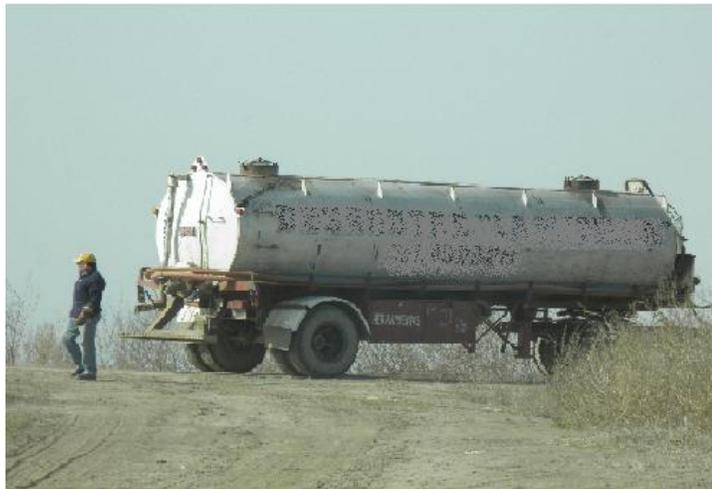
Figura N° 10: Descarga de camión atmosférico sobre una de las laguna de tratamiento secundario.
