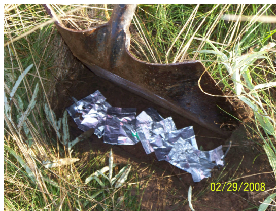
Foto 1. Conjunto de tempils colocados a 2 cm de profundidad.
