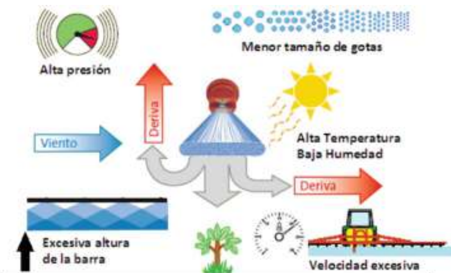
Fig. N° 51: muestra gráfica de cómo se produce la deriva. (Fuente: Brambilla, 2016:21)
