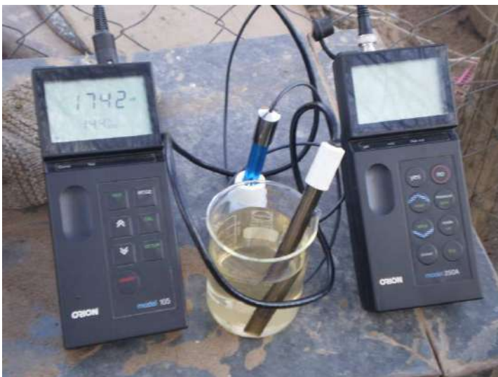
Fotografía 24. Medición de conductividad eléctrica y pH.
