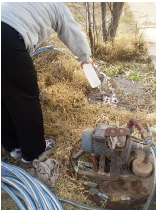
Fotografía 26. Toma de muestra correspondiente a una bomba eléctrica.
