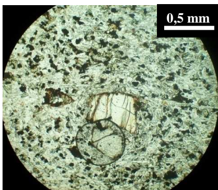
Figuras 16 (izq.) y 17 (der.): Vista al microscopio petrográfico (izquierda) luz polarizada y (derecha) luz natural de la textura porfírica con fenocristales de olivino en una pasta traquítica de los diques.
