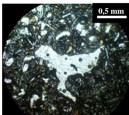
Figuras 14 (izq.) y 15 (der.): Fotografías al microscopio petrográfico con luz polarizada (izquierda) y luz natural (derecha). Se observa la estructura vesicular y textura porfírica de los aglomerados volcánicos con fenocristales alterados totalmente a iddingsita.
