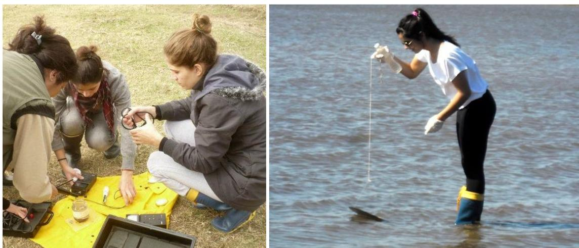
**Fig. 6.** Mediciones in situ de pH, conductividad, oxígeno disuelto y transparencia con disco de Secchi.
