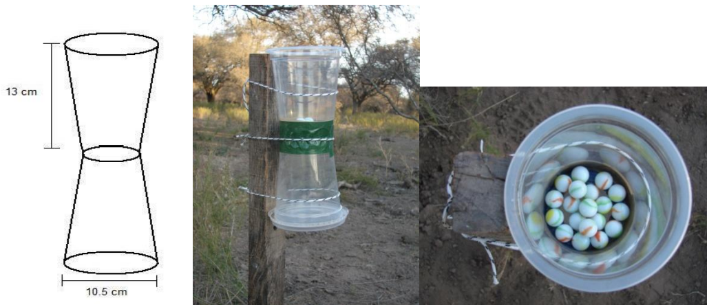
Figura 4: Esquema de colectores utilizados para el muestreo
