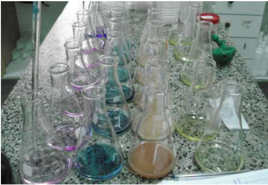
Determinación de calcio (pasa de fucsia a púrpura); determinación de dureza (pasa de fucsia a un celeste pasando por violeta, luego al azul y por ultimo a celste); determinación de cloruros (pasa del amarillo a terracota claro); y determinación de alcalinidad (pasa de celeste azulado a amarillo).
