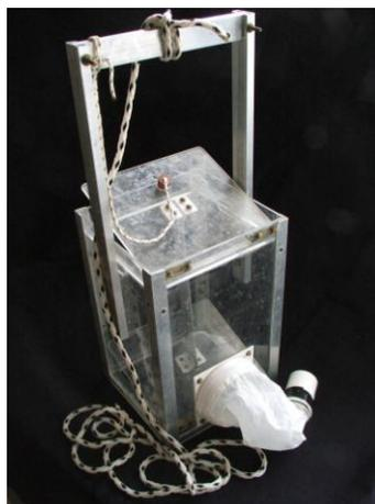
**Figura 4: Trampa de Schindler-Patalas de 10 l de capacidad empleada en la toma de muestras de zooplancton**
