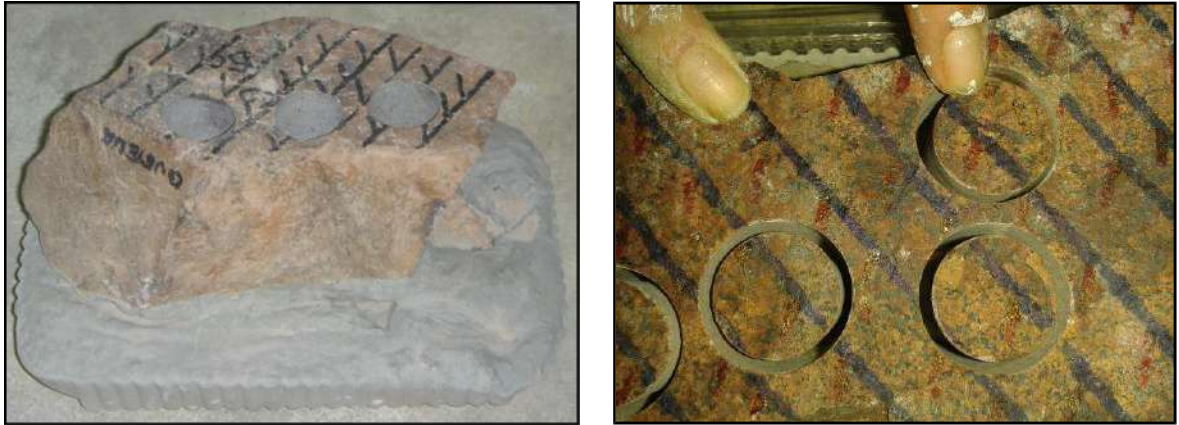
Figura 4.7. Fotografías donde se puede apreciar en las muestras de mano la cara orientada y la repetición de la marca de orientación cubriendo la superficie de las mismas.
