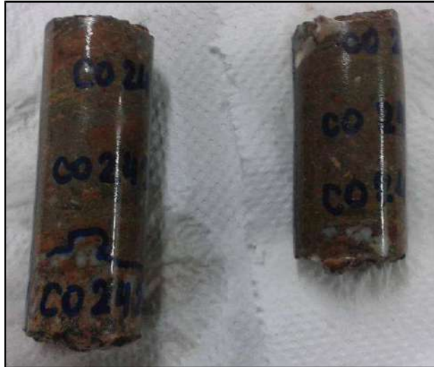
Figura 4.2. Cilindros orientados extraídos con la perforadora portátil.
