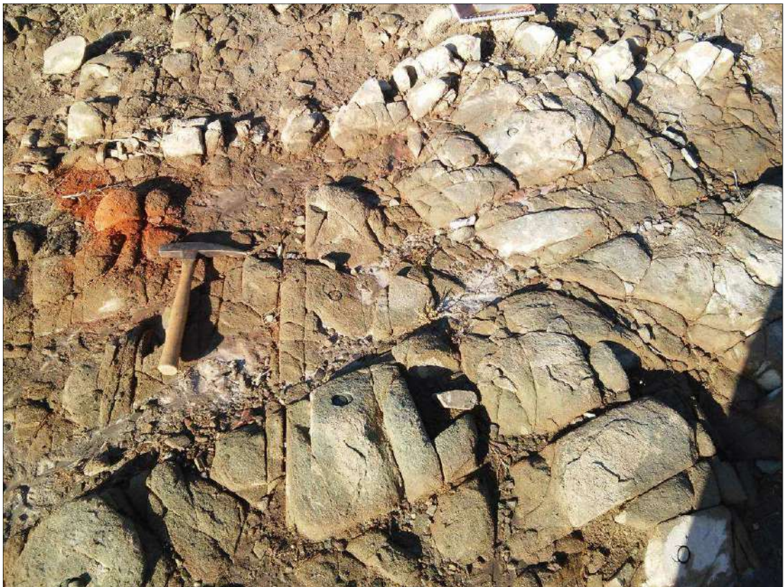
Figura 5.8. Sitio de muestreo PH-3. Tal como puede apreciarse en la imagen se trata de un sub-afloramiento de areniscas de grano medio a grueso que presentan mayor friabilidad y meteorización que las litologías de grano más fino.
