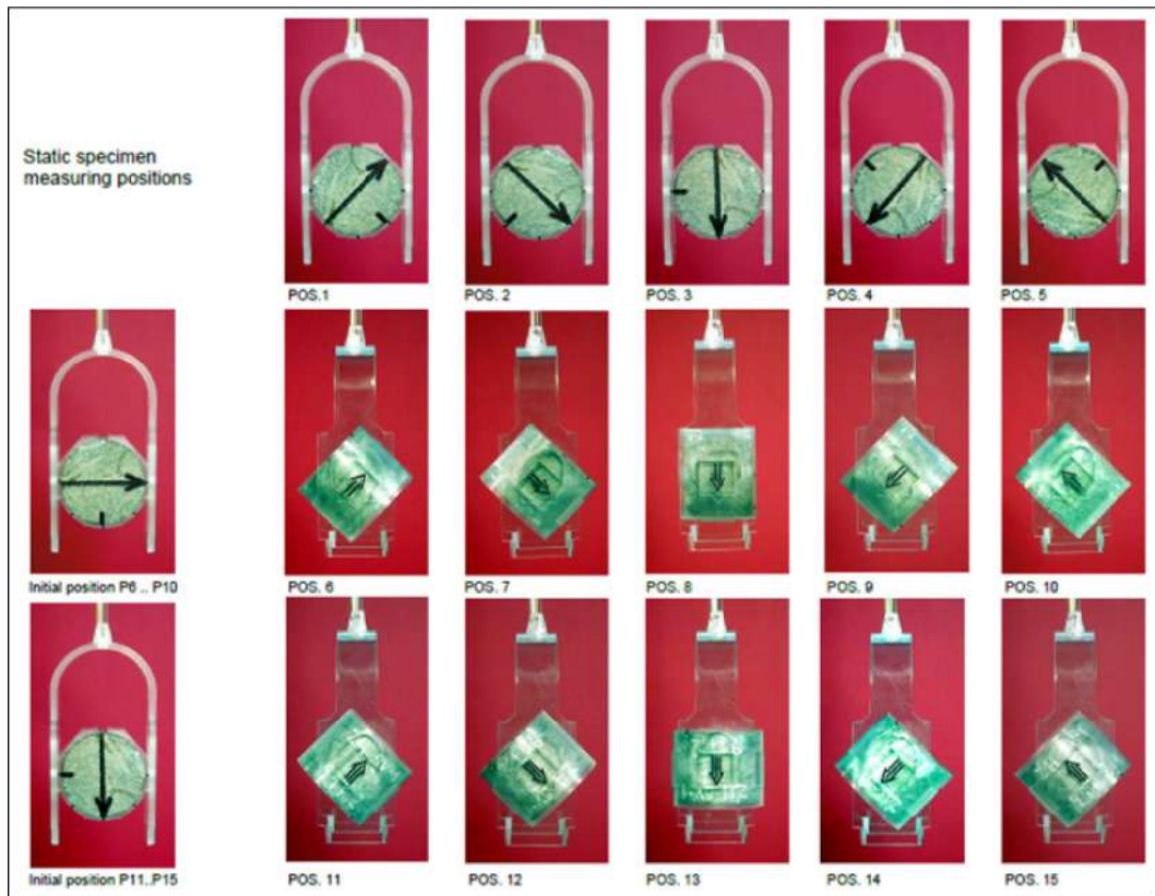
Figura 4.12. Posiciones de medición para un espécimen estático. Extraído del Manual de KAPPABRIDGE-AGICO.
