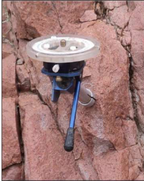
Figura 4.3. Orientador con las brújulas tipo Brunton y solar en su parte superior. Se observa en su parte inferior derecha la ranura donde se introduce un alambre de cobre para trazar la línea fiduciaria.
