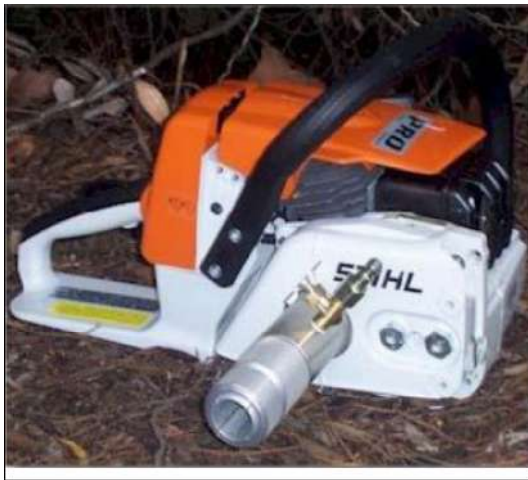
Figura 4.1. Perforadora portátil para la obtención de los cilindros (izquierda). Vista general de los afloramientos en la zona de muestreo (derecha).
