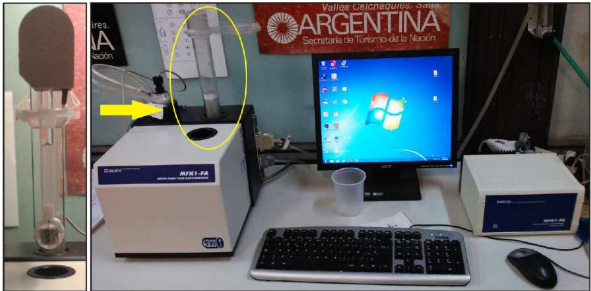
Figura 4.11. Equipo Kappabridge KLY-2 (Geofyzika Brno), utilizado para medir la Anisotropía de Susceptibilidad Magnética, con detalle del porta muestra, para la medición automática.
