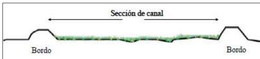
Figura 5.9. Canal de bordos (Cisneros et al., 2012).
