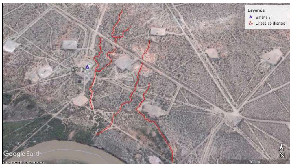
Figura 6.3. Diseño de drenaje del área de estudio (Elaboración a partir de Google Earth).
