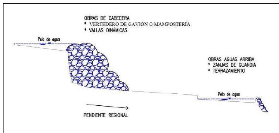
Figura 6.39. Medidas estructurales aplicables en carcava al Sudoeste del Pozo LP- 1015.
