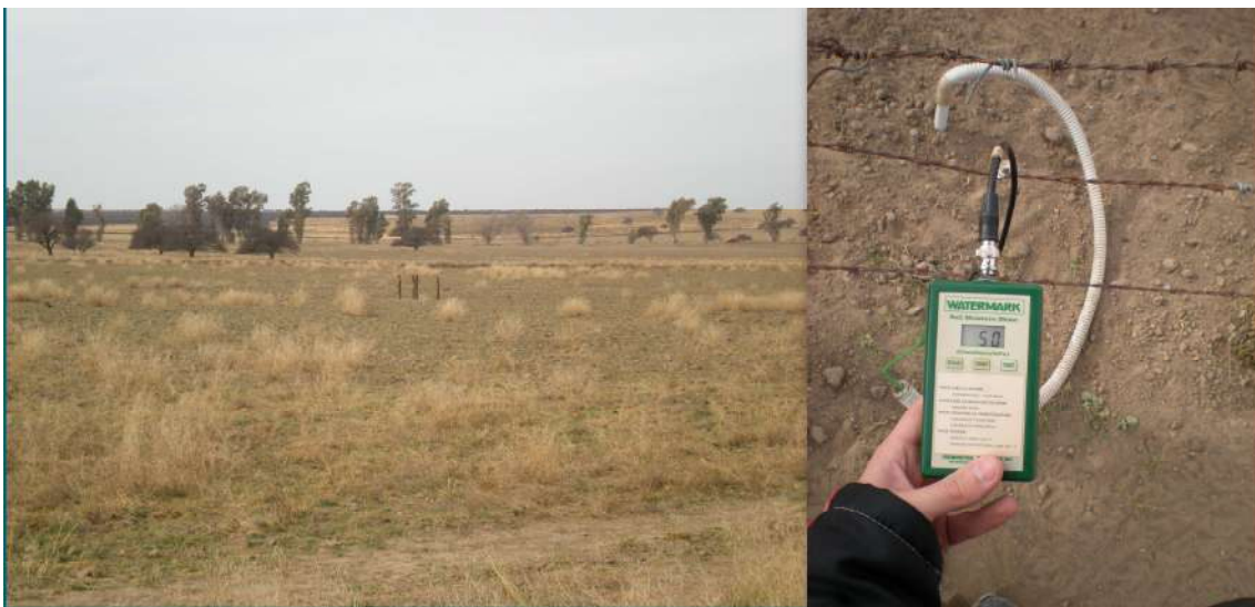
Figura A3. Ubicación y toma de datos del tensiómetro localizado en el ambiente de cultivos con prácticas agrícolas conservacionistas.
