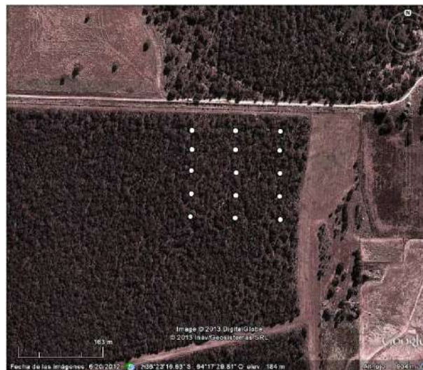
Figura 3.12. Distribución espacial de los ensayos de penetrometría en el sitio de Bosque de caldén. Círculos blancos indican sitios de ensayo.
