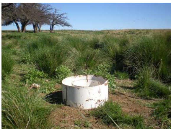
Gráfico A8. Ensayo de infiltración en el ambiente de pasturas y cultivos.
