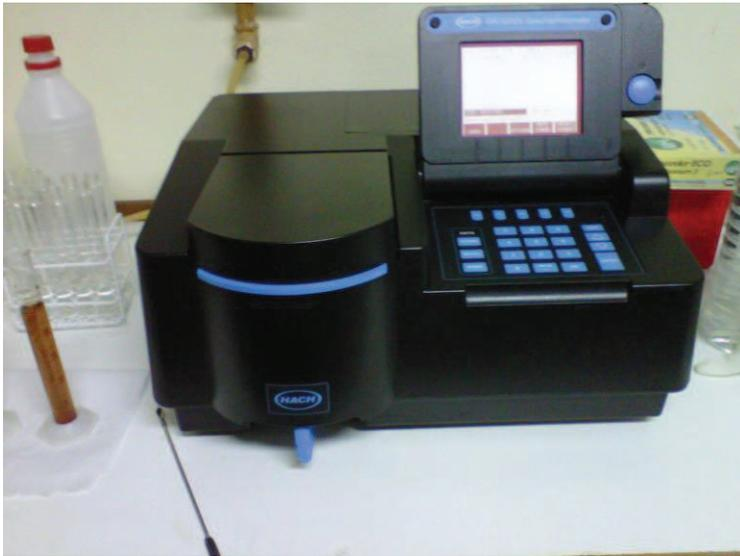
**Foto 4.** Espectrofotómetro UV-Visible, Marca HACH.
