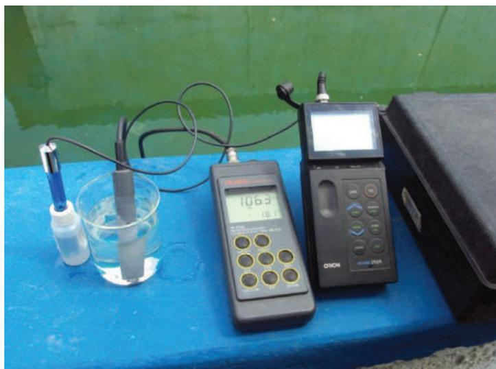
**Foto 3.** Conductímetro y pHmetro.
