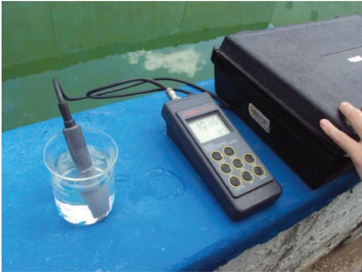
**Foto 1.** Conductímetro Marca HANNA Instruments HI 9635. También medidor de T °C.
