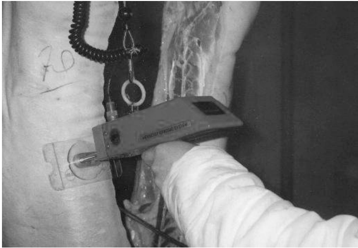
Fotografía 4. Sonda de penetración Hennesy Grading Probe
