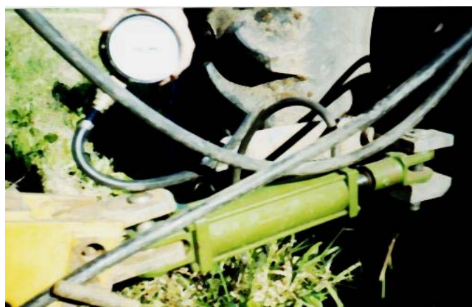
Figura 8: Dinamómetro de principio hidráulico usado en los ensayos de tracción.
