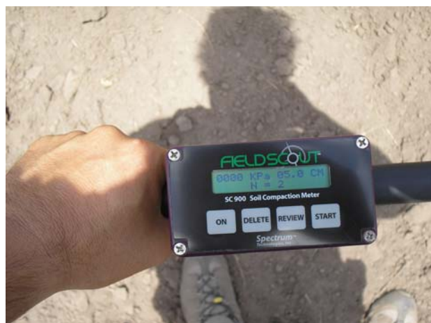
Figura 6: Medición de la Resistencia a la penetración mediante un penetrómetro SCOUT 900
