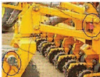
Figura 5. Sensor en la rueda y activador de siembra cuando la máquina está clavada.
