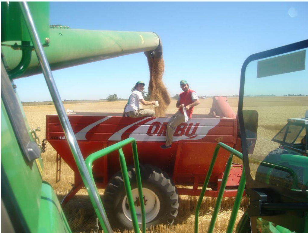
FOTO 10: Toma de muestra tubo maquina JOHN DEERE.
