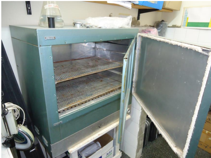
FOTO 11: cámara de germinación donde se colocaron las bandejas de germinación.
