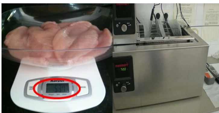
Figura 5.1: (izquierda) peso y cocción de las muestras, figura 5.2 (derecha) baño térmico para las muestras.
