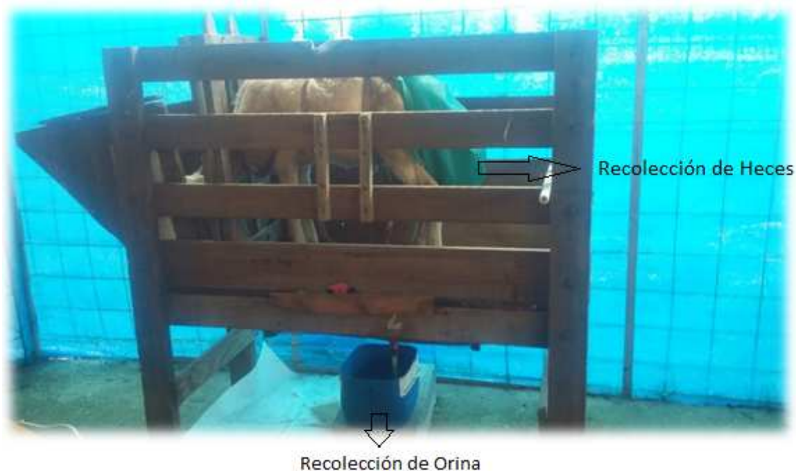
Foto 2. Jaula metabólica para ovinos: ubicación del recipiente de recolección de orina y arnés para la recolección de heces.
